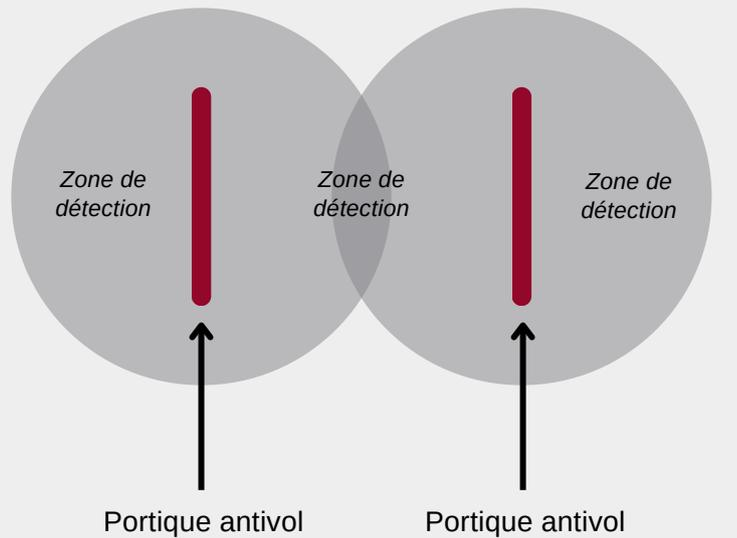
**DISTANCE DE DÉTECTION : JUSQU'À 1,80 M
